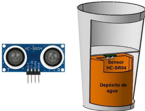
Fig. 4. Sensor HC-SR04 montado sobre el prototipo de la maceta.
