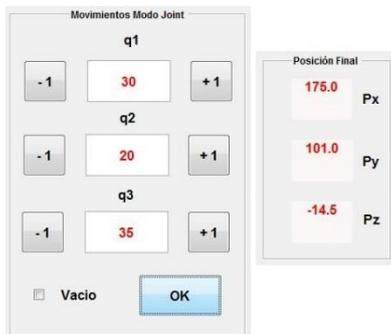
Figura 11. Control de movimientos articulares y posición final  $P_x, P_y, P_z$ .
