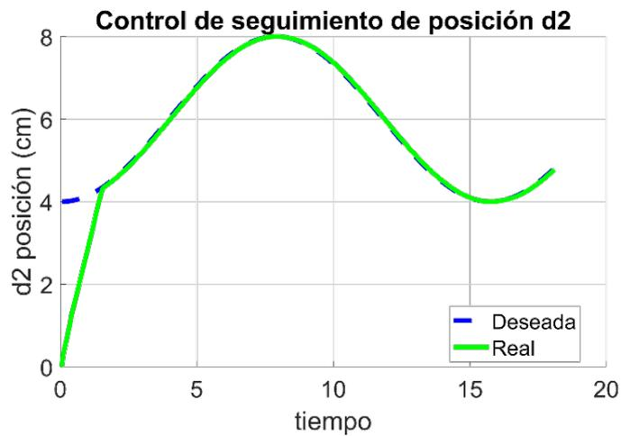
Fig. 25. Control de seguimiento de la trayectoria en la posición lineal  $d_2$ .
