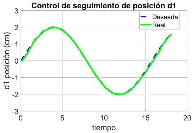
Fig. 23. Control de seguimiento de la trayectoria en la posición lineal  $d_1$ .
