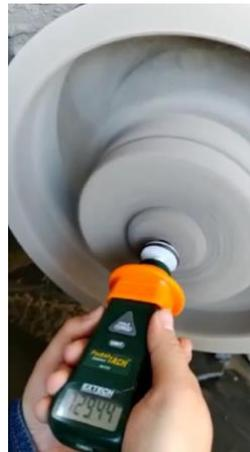
Figura 9: Medición de las revoluciones del motor
