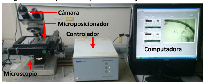
Fig. 1. Microscopio automatizado en escaneo 2D para adquirir las imágenes sobre la muestra.
