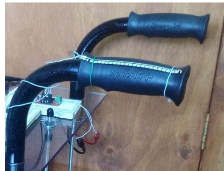
Figura2. Ubicación de la galga extensiométrica.
