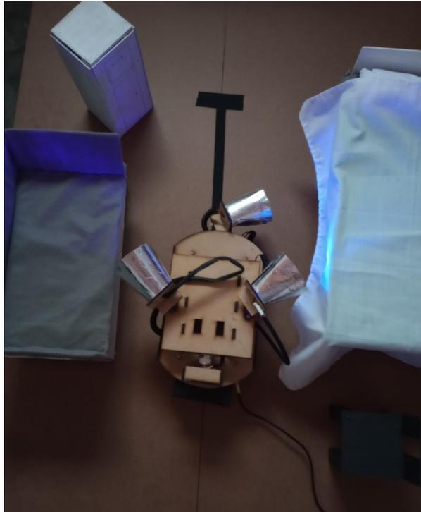
**Figura 17.** Irradiación observada sobre los muebles de la habitación en las pruebas de campo.
