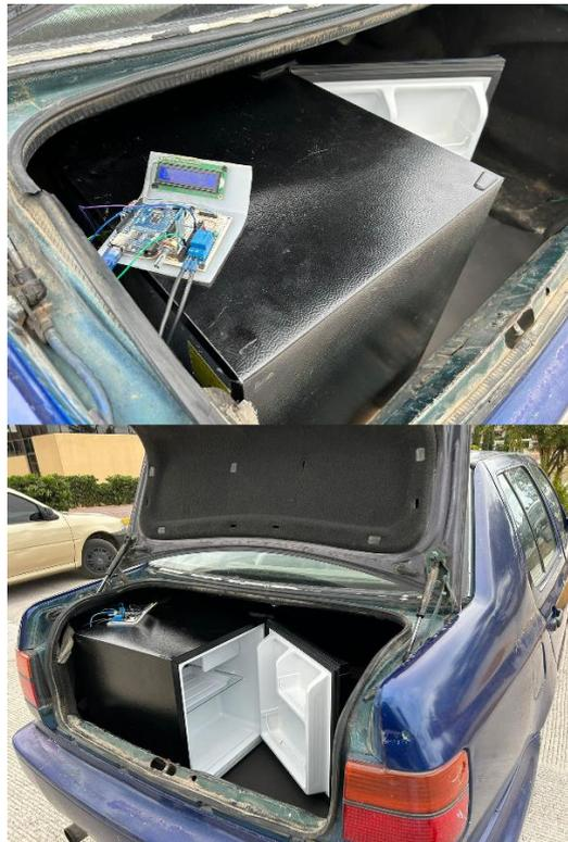
**Figura 6** Frigobar adaptado en el automóvil
