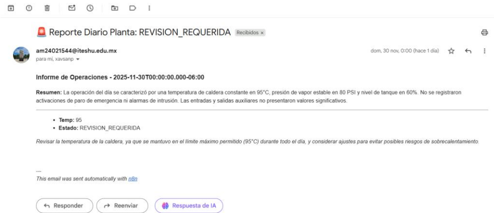
Figura 4. Ejemplo de reporte técnico por correo generado automáticamente por el agente de IA.
