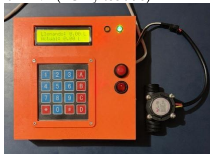
Figura 2. Prototipo funcional para simular fugas de agua en sanitarios
