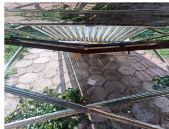
Figura 4. Fotografía del calentador solar de agua con espejos en ángulo \alpha = 8.49^\circ
