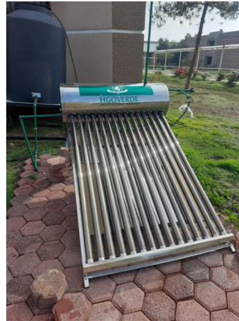
Figura 3. Fotografía del calentador solar de agua con espejos en ángulo \alpha = 0^\circ .
