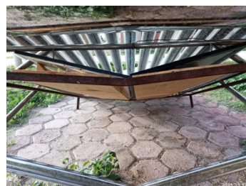
Figura 5. Fotografía del calentador solar de agua con espejos en ángulo \alpha = 30^\circ .
